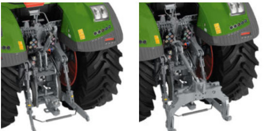
Bagerste lift med kuglens ender og gummiophæng
