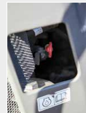
Pas de capteur de niveau d'huile, le contrôle se fait encore à la jauge.
