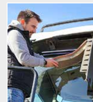
Il y a beaucoup de vis à enlever pour accéder aux filtres de la cabine.
