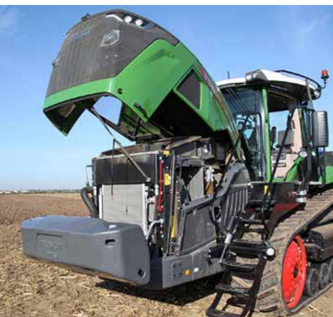
Sous l'énorme capot, le six cylindres MAN est silencieux et économique. La zone du radiateur est complètement isolée du moteur.
