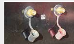
L'utilisation de câbles démarrage ne pose aucun problème, les bornes de la batterie étant à l'extérieur.
