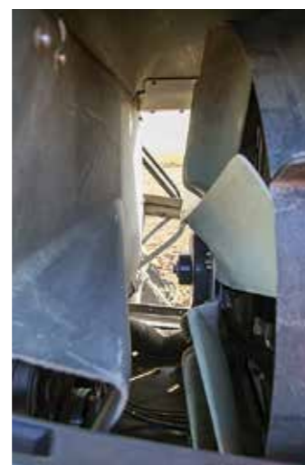
Sous l'énorme capot, le six cylindres MAN est silencieux et économique. La zone du radiateur est complètement isolée du moteur.
