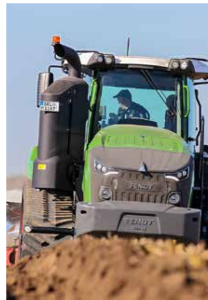
L'énorme pot d'échappement regroupe le système de dépollution des gaz d'échappement Stage V complet avec DOC, SCR et DPf.
