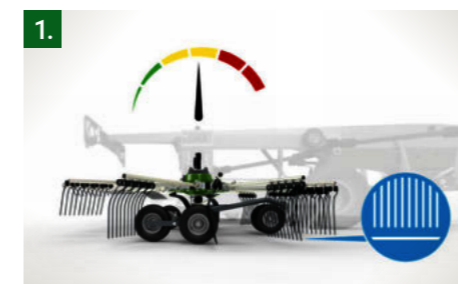
1. Elindulás Mind a négy rotor leereszkedik az előre beállított munka magasságra.
