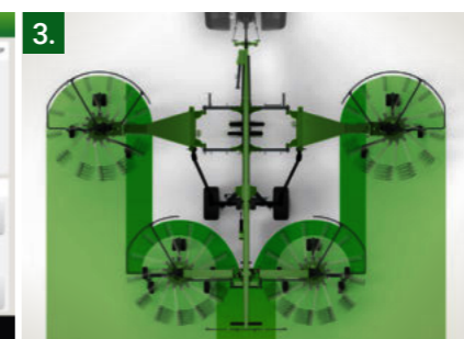
A GapControl optimális átfedést biztosít a mellső és hátsó rotorok között, ezzel elősegíti a munkaszélesség hatékony kihasználását
