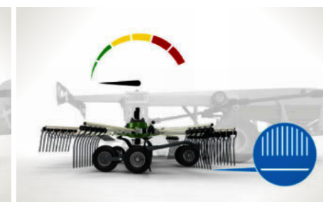
3. Megállás Mind a négy rotor felemeli a fogakat a beállított munka magasság fölé.
