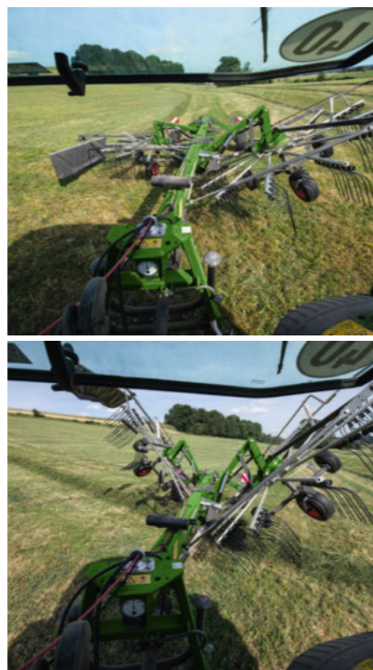
Az alapfelszereltségként beépített sorrendszabályozás tökéletes rendeket eredményez a táblavégi fordulókban, a tábla szélein és sarkain is
