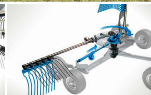
A módosított vezérlőpálya-beállítás optimalizálja a fogak kiemelési időpontját.
