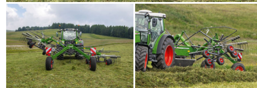
A rendterelő ponyva a táblavégi fordulóban és a szállítási pozícióban automatikusan felhajtásra kerül.
