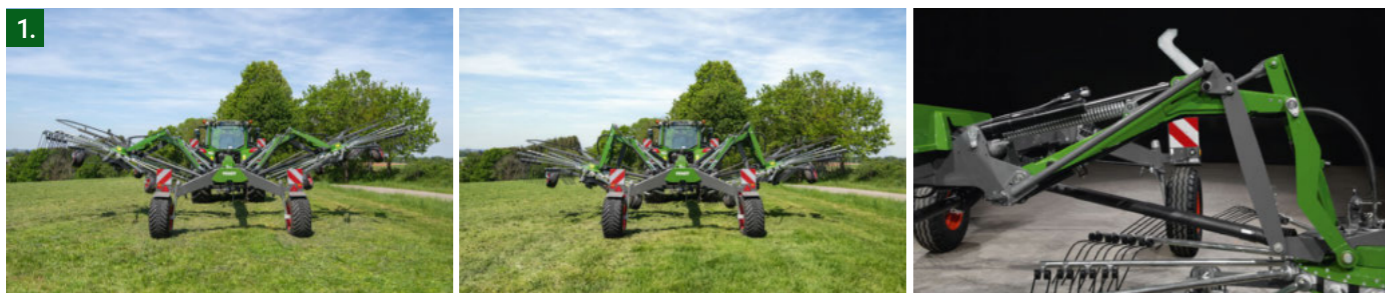
A rend- és munkaszélességek alapfelszereltségként hidraulikusan, PRO-modellek esetében pedig ISOBUS-vezérléssel állíthatók
