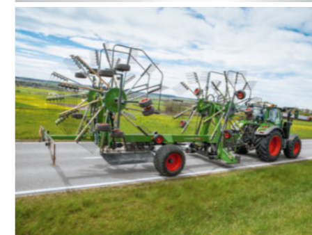
Az emelőtengely vastag abroncsozása szintén hozzájárul a talajnyomás csökkentéséhez.
