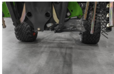
Az opcionális hidraulikus rendterelő ponyva a rotor kiemelésékor automatikusan a felhajtott pozícióba kerül, így a keresztirányú rendeken és az egyenetlen utakon is könnyebb az áthaladás.
