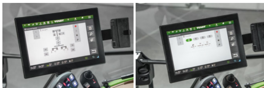
ISOBUS UT: A kezelő képernyők átvihetők a traktor terminálra ISOBUS AUX-N: a vezérlőkar átvitele lehetséges
