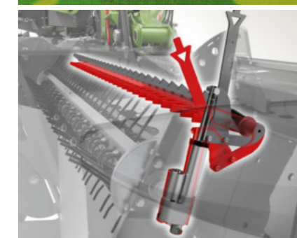
Elektrimootor juhib astmevabalt muljuri vastukammi, mis vastutab muljumise intensiivsuse eest
