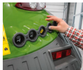
Takanostolaitetta, voimanottoa ja yhtä hydrauliikkalohkoa voidaan ohjata kummastakin takalokasuojasta.
