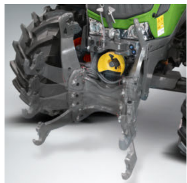
Takanostolaitetta, voimanottoa ja yhtä hydrauliikkalohkoa voidaan ohjata kummastakin takalokasuojasta.
