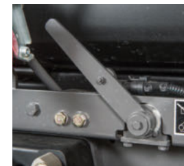
Vetovarren lukitus sulkuventtiilillä estää kytkettyjen työkonoiden vaurioitumisen ja väärinkäytön.
