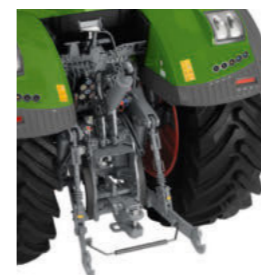
Elevador trasero con enganche de cierre rápido y cuñas de ajuste (EEUU)
