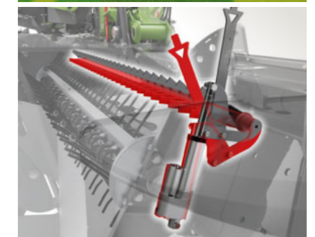
Elektrinis variklis bepakopiu būdu reguliuoja plaušintuvo, kuris atsako už apdoravimo intensyvumą, priekines šukas
