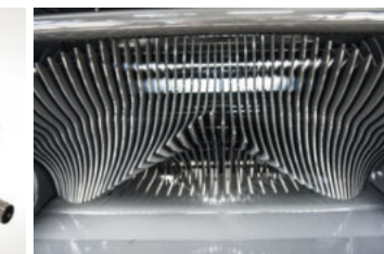
XtraCut25 rotor - Aprítóegységgel: max. 25 késsel
