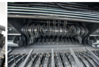
XtraCut13 rotor (ujjpár távolság: 90 mm) - Szeletelőszerkezet nélkül (sorozat) - Aprítóegységgel: max. 13 késsel
