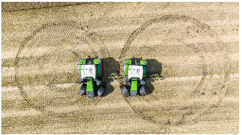
Inequivocabile: Il telaio slanciato consente al nuovo 724 Vario Gen7 (a sinistra) un angolo di sterzata più stretto. Peraltro in questo caso erano anche montati pneumatici anteriori comparativamente piccoli.
