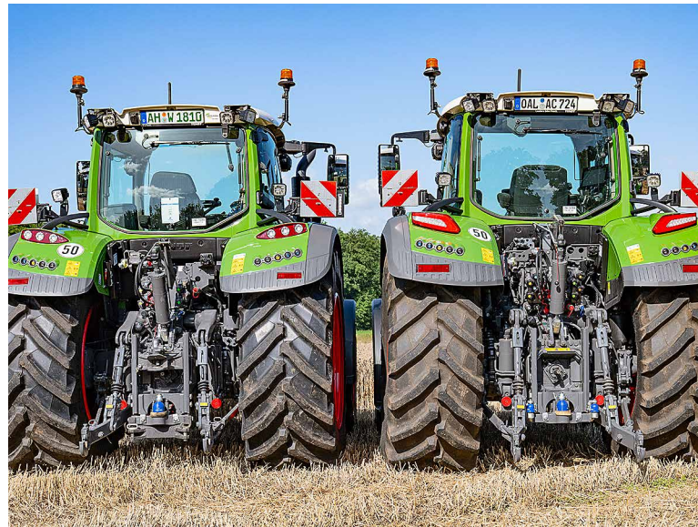
Ampia corsa di sollevamento, molte centraline e attacchi perfettamente accoppiabili: guardando la parte posteriore il vecchio modello (sinistra) e quello nuovo (destra) si distinguono appena.
