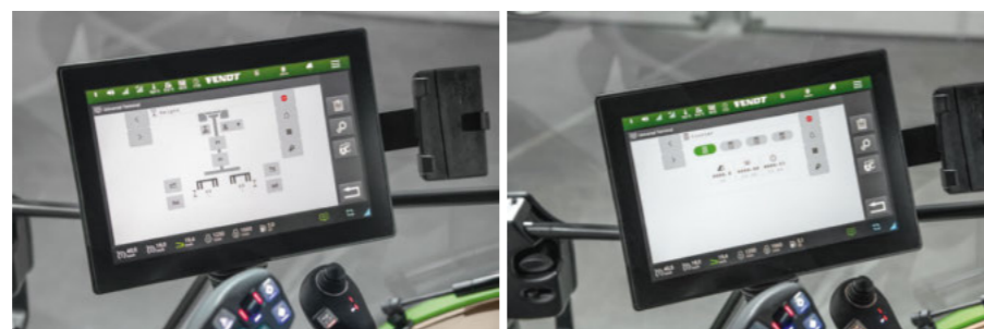
ISOBUS UT: Betjenings-skærme kan overføres til traktorterminalen ISOBUS AUX-N: En overførsel af styrehåndtaget er mulig
