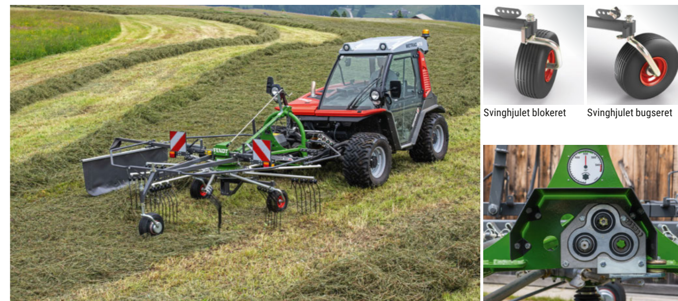
Universaltransmissionen af støbt letmetal til front- eller bagerste opgaver
