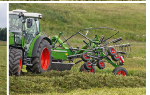
Skårdugen foldes automatisk op i forager- eller transportposition.
