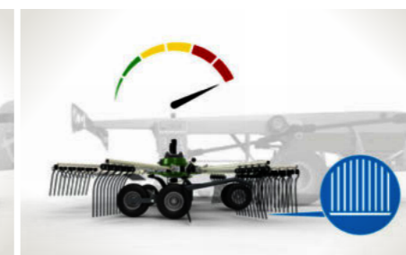
2 Forøgelse af kørehastighed Alle fire rotorer sænkes afhængigt af kørehastigheden under den forindstillede rivehøjde.
