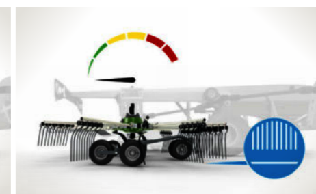
3 Stilstand Alle fire rotorer hæver tænderne over den indstillede rivehøjde.
