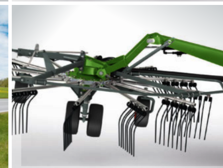
Funktionel trinløs arbejdsbreddetilpasning takket være patenteret dobbelt svingarm.
