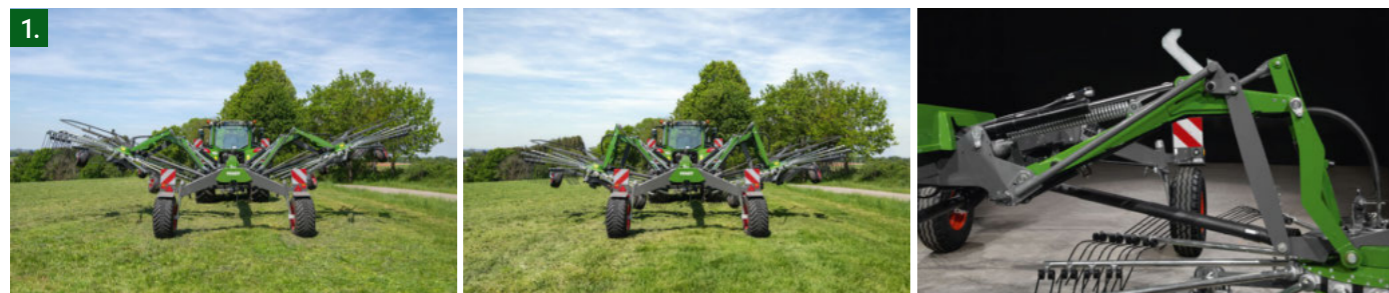
Skår-/arbejdsbreddestyring som standard hydraulisk og for PRQO-modeller via ISOBUS
