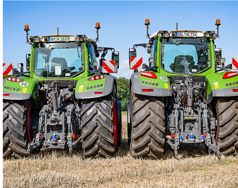
Großer Hubweg, viele Steuergeräte und perfekt kuppelbare Anschlüsse: im Heck unterscheiden sich alt (links) und neu (rechts) kaum.
