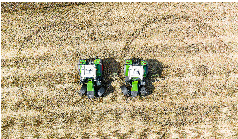
Eindeutig: Der schlanke Rahmen ermöglicht dem neuen 724 Vario Gen7 (links) einen engeren Lenkeinschlag. Hier waren allerdings auch vergleichsweise kleine Vorderreifen aufgezogen.
