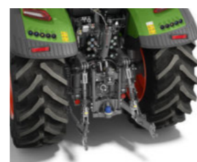
Задній навісний пристрій з автоматичним гаками на кінцях тяг та бічними упорами
