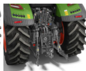
Задній навісний пристрій з автоматичними гаками на кінцях тяг та гумовими демпферами (Австралія, ПАР, Східна Європа)
