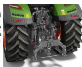
Рама Quick Hitch з гідравлічним розкриттям зачіпних гаків у стандартній комплектації
