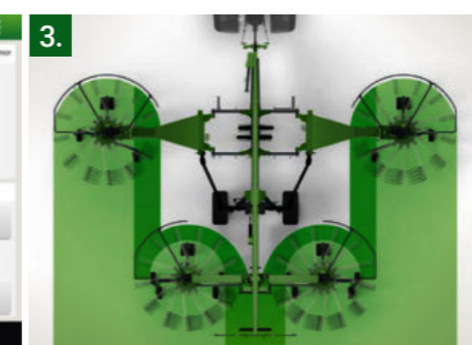
GapControl säkerställer optimal överlappning mellan främre och bakre rotorerna och därmed ett effektivt utnyttjande av arbetsbredden
