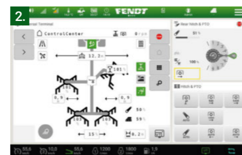
1 Start Alla fyra rotorerna sänks till den förinställda strängläggningshöjden.
