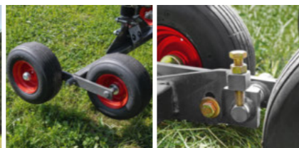
Tandemaxel som tillval Inställning av tvärlutning 300
