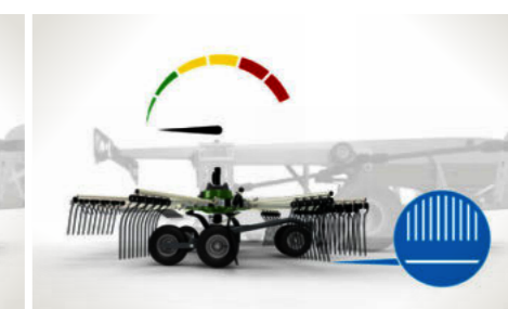
3 Stillestånd Alla fyra rotorerna lyfter räfsarna över den inställda krattningshöjden.
