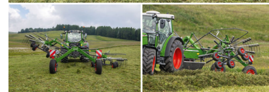
Strängduken faller upp automatiskt i vändtegs- eller transportläge.
