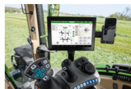
ISOBUS UT: Manöverskränningar kan överföras till traktorns terminal ISOBUS AUX-N: Överföring av styrspek är möjlig
