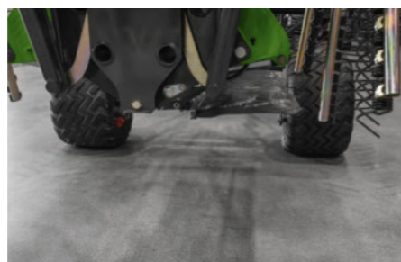
Den hydrauliska strängformaren (tillval) fälls automatiskt upp när rotorerna höjs och gör det lättare att korsa höga strängar och transportera på ojämna fältvägar.
