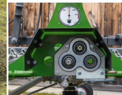
Universalväxellåda av gjuten lättmetall för fram- och bakväxling.
