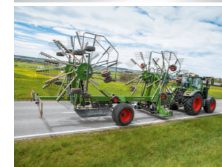
De stora däcken på lyftaxeln ger också ett lägre marktryck.
