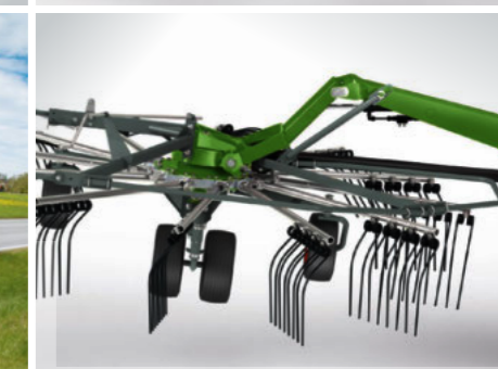
Funktionell, steglöst justerbar arbetsbredd tack vare patenterad dubbel vippanordning.
