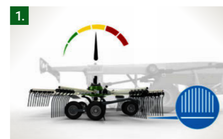
1 Start Alla fyra rotorerna sänks till den förinställda strängläggningshöjden.
