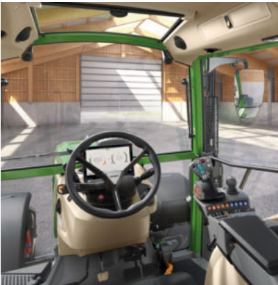
Profi Setting 1 - Alavanca monocomando em cruz - 2 módulos lineares (par de balancim) para controlar distribuidores hidráulicos
