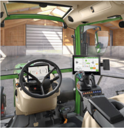
Profi Setting 2 - Joystick 3L - 2 módulos lineares (par de balancim) para controlar distribuidores hidráulicos - Terminal de 12"
