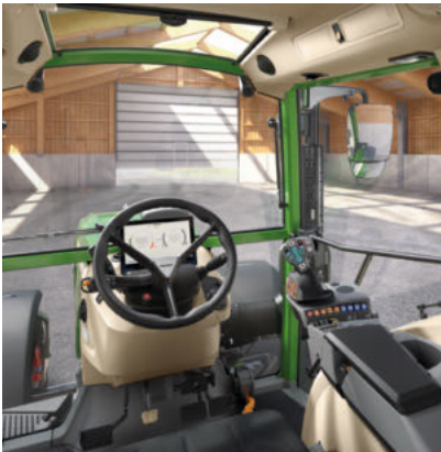
Power Setting 1 - Sem alavanca monocomando em cruz - 2 módulos lineares (par de balancim) para controlar distribuidores hidráulicos
