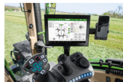
ISOBUS UT: okienka obsługi można przenieść do terminala ciągnika ISOBUS AUX-N: przeniesienie dźwigni jazdy jest możliwe
