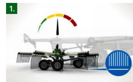
1 Uruchomienie Wszystkie cztery rotory opuszczają się do ustawionej wysokości zgrabiania.
