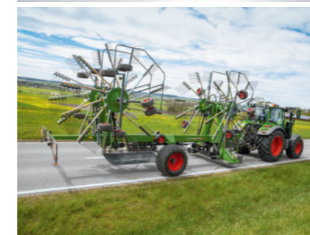
Opony o dużej objętości na osi unoszonej zapewniają również mniejszy nacisk na podłoże.
