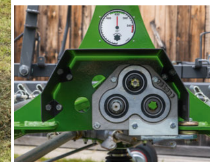
Uniwersalna przekładnia z odlewem z metalu lekkiego do obsługi przedniej i tylnej.
