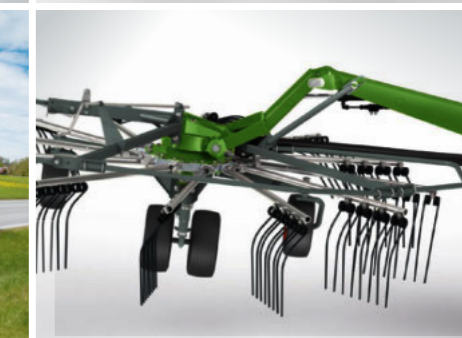
Funkcjonalna, bezstopniowa regulacja szerokości roboczej dzięki opatentowanemu podwójnemu ramieniu.
