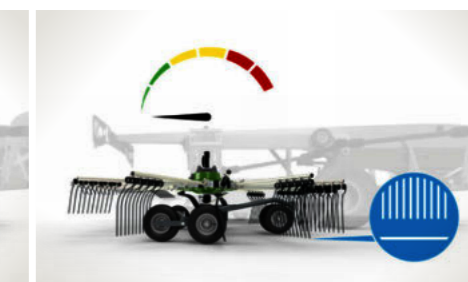
3 Zatrzymanie Wszystkie cztery rotory podnoszą palce powyżej ustawionej wysokości zgrabiania.
