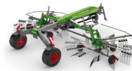
Zgrabiarka środkowa z podwoziem transportowym Elastyczne szerokości robocze pokosu z łatwą obsługą Szerokość robocza 5,80 – 10,00 m
