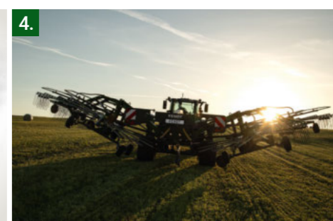
3 Zatrzymanie Wszystkie cztery rotory podnoszą palce powyżej ustawionej wysokości zgrabiania.
