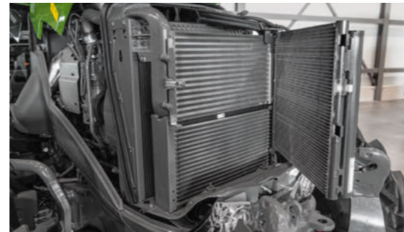
Mazāk piepūles: kompaktnajam radiatora blokam ir ļoti viegli piekļūt; tas ir viegli un ātri iztīrāms, jo ir plašs atstatums starp dzesētājiem un plakano radiatora apakšdaļu.
