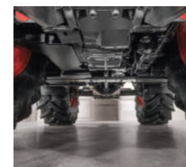
■ Īsts klīrens līdz 50 cm – nav tādu zemu detaļu kā atturi vai kabeļi
