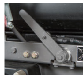
Nepieļauj pievienoto agregātu nepareizu lietošanu un bojājumus: uzkares roka tiek nostiprināta ar slēgvārstu.
