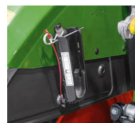
Droša glabāšanas vieta: pilnīgi iebūvēts lodveida separators uz iekšējā dubļusarga.
