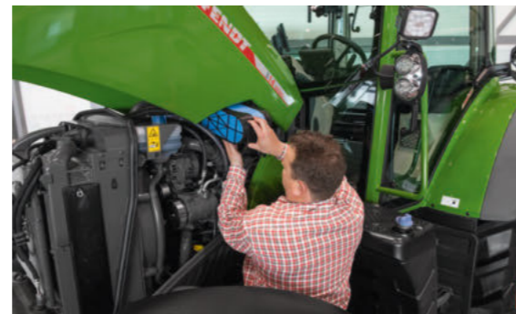
Gaisa filtrs ar augstiem ekspluatācijas rādītājiem nodrošina optimālu gaisa ieplūdi, ir viegli tīrāms un nomaināms.
