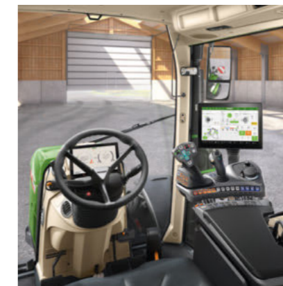
Profi Setting 2 - 3L vadības svira - 1 lineārais modulis (taustiņslēdžu pāris) hidroizvadu vadīšanai - 12 collu terminālis
