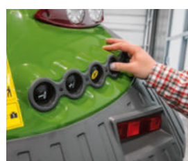
Aizmugurējo uzkaru, jūgvārpstu un vienu hidrovārstu var vadīt no kāda no aizmugurējiem spāniem.
