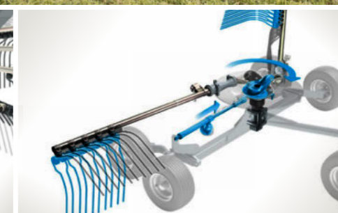
La modification de la position du chemin de came optimise le moment de levage des dents.
