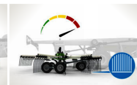
2 Augmenter la vitesse de déplacement Les quatre rotors s'abaissent en dessous de la hauteur de ratissage prédéfinie en fonction de la vitesse de déplacement.
