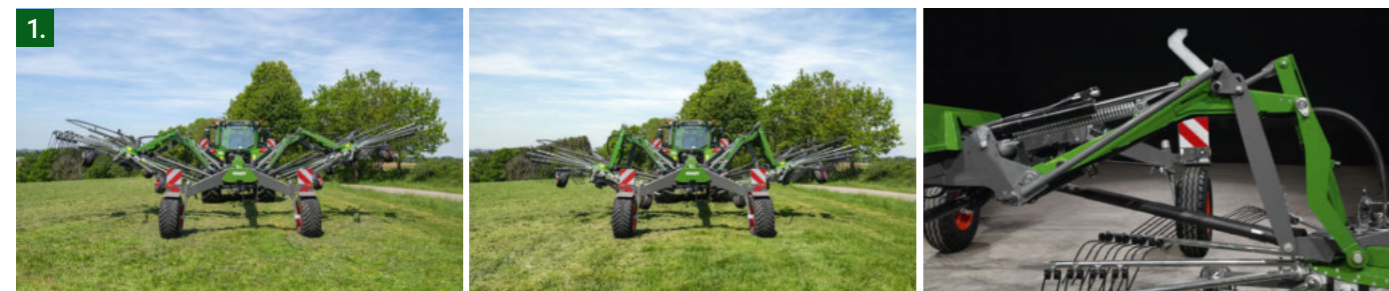
Réglage hydraulique de l'andain/de la largeur de travail de série et par ISOBUS sur les modèles PRO
