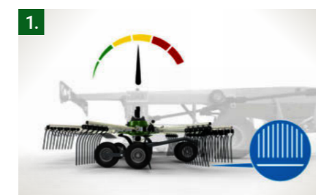
1 Démarrage Les quatre rotors s'abaissent jusqu'à la hauteur de ratissage prédéfinie.
