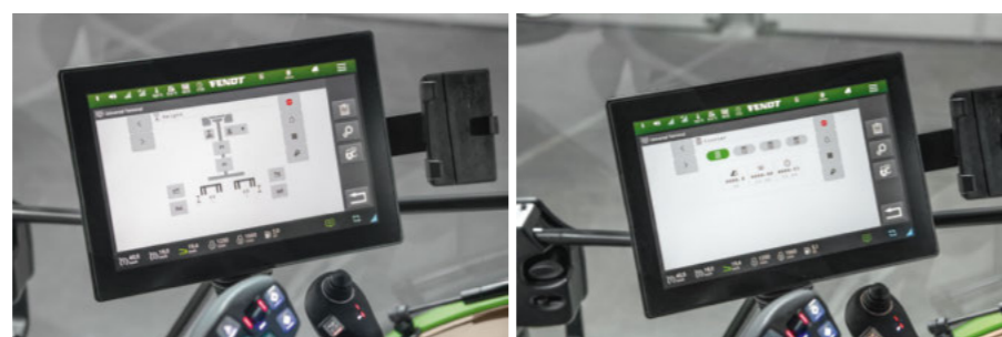
ISOBUS UT : Les masques de commande peuvent être transférés sur le terminal du tracteur ISOBUS AUX-N : Le transfert du levier d'accélération est possible
