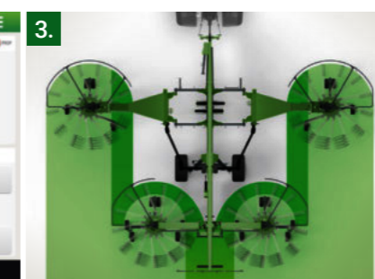
Le GapControl garantit un chevauchement optimal des rotors avant et arrière et donc une utilisation efficace de la largeur de travail
