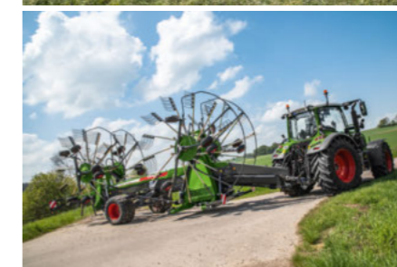
Attelage intelligent : Le capteur d'angle avertit en cas de braquage trop serré
