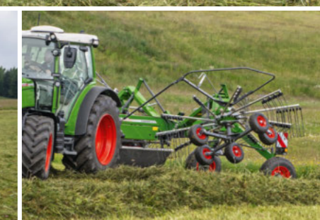
La toile d'andain se relève automatiquement en position de bout de champ ou de transport.
