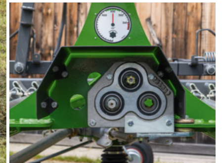
Réducteur universel en fonte d'alliage léger pour une utilisation à l'avant et à l'arrière.
