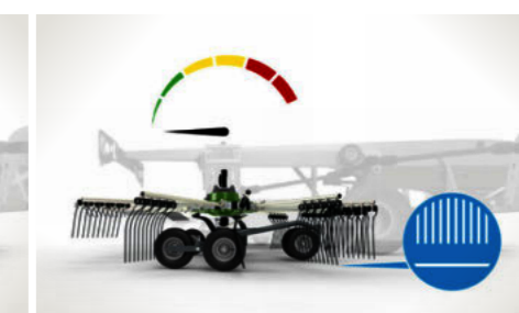
3 Arrêt Les quatre rotors soulèvent les dents au-dessus de la hauteur de ratissage réglée.
