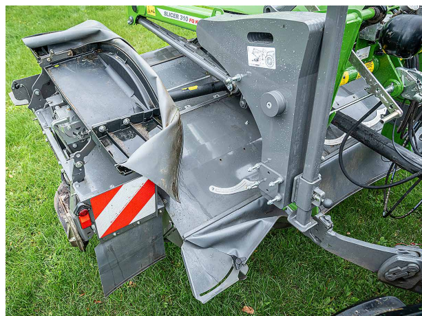
Les contrepoids sur la faucheuse frontale optimisent la répartition de la charge. Le servomoteur (en haut) ajuste le conditionneur.
