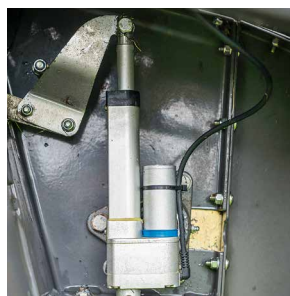
Les contrepoids sur la faucheuse frontale optimisent la répartition de la charge. Le servomoteur (en haut) ajuste le conditionneur.
