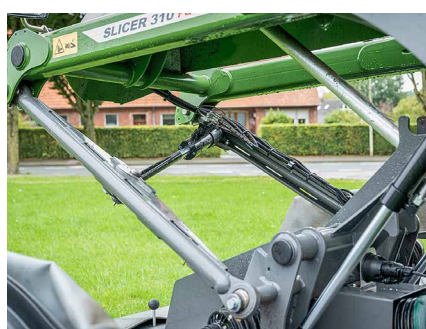
Un vérin assure le guidage actif de la faucheuse frontale.
