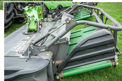
Les tapis sont désormais équipés de lattes de transport séparées et vissées.
