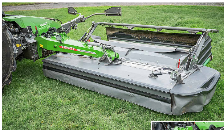
Le bras est fixé au milieu de l'unité de fauche. Un vérin assure la stabilité des unités soulevées.
