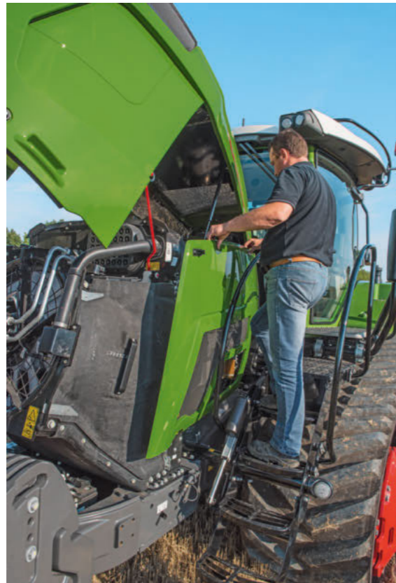
A motortér a levehető oldalsó elemek miatt nagyon jól hozzáférhető.
