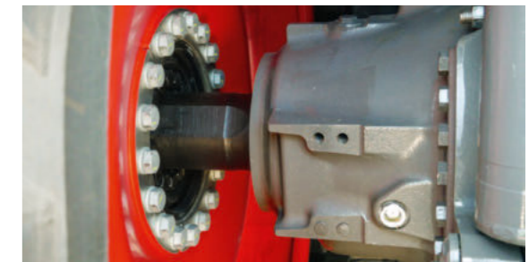
A robusztus hátsó tengely rendkívül hosszú élettartamú. Az olajsínt a rendelkezésre álló kémlelőnyílásokon kényelmesen ellenőrizhető.
