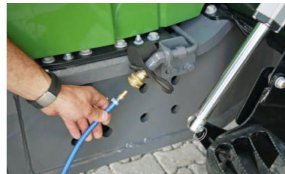
A gép elején található egy sűrítettlevegő-csatlakozás, amely segítségével a hűtőkből a szennyeződések kényelmesen kifújhatók.
