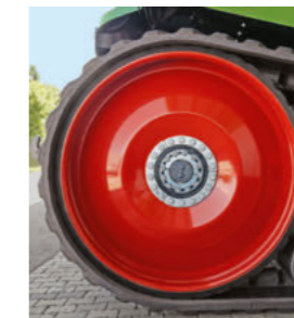
A jó teljesítmény-átvitelről a hátsó meghajtókerekek gondoskodnak, amelyek súrlódáson keresztül hajtják meg a hevedereket.
