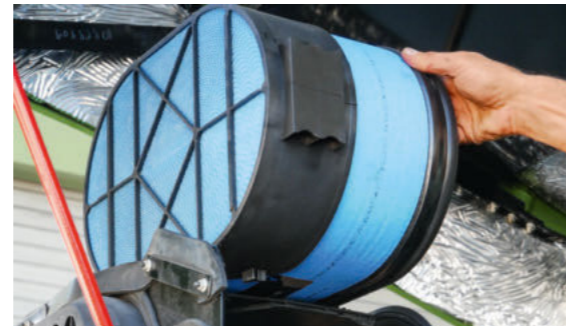
A légszűrőt könnyű cserélni és mindazonáltal van benne egy szennyeződésezékelő, amely a szűrő hatékonyságáról tájékoztat.
