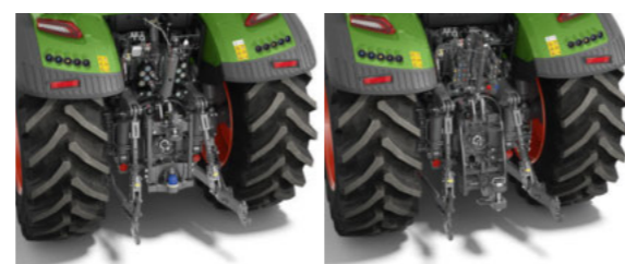
Levante traseiro com ganchos de acoplamento rápido e estabilizador lateral (UE)
