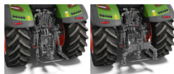
Levante traseiro com acoplamento esférico e blocos de fricção para estabilizar deslocamento lateral
