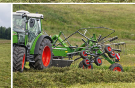
Vāla aizsargs automātiski salocīsies uz augšu lauka galā vai transportēšanas pozīcijā.
