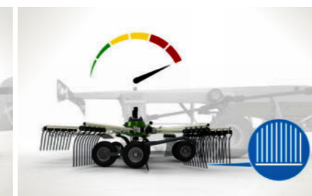
2. Braukšanas ātruma palielināšana Visi četri rotori nolaižas zemāk par iepriekš iestatīto grābšanas augstumu atkarībā no braukšanas ātruma.
