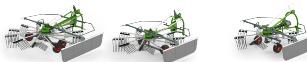
Trīspunktu montāža ar velkamo iekārtu Daudzpusība un vienkāršība izmantošanā Darba platumi 3,40 – 4,50 m
