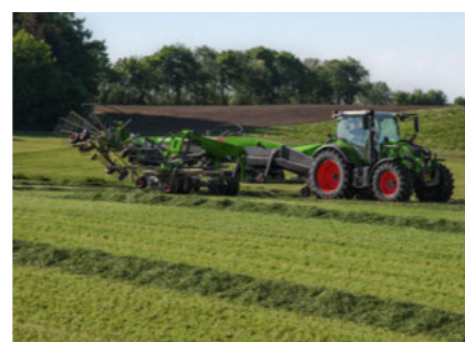
Pateicoties jaunajai ISOBUS sistēmai, inovatīvā sekvences vadība tiek veikta elektroniski, izmantojot laika vai attāluma signālu, un to var pielāgot atbilstoši individuālām vajadzībām.
