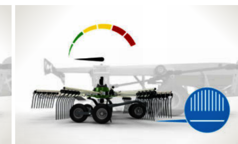
3. Apstāšanās Visi četri rotori paceļ zarus virs iestatītā grābšanas augstuma.
