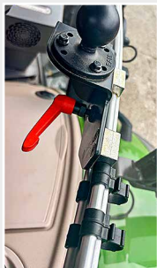
Rail esthétique avec fixation Ram et passage de câbles.
