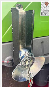
Simple, sûr et silencieux : le magasin à rotules.
