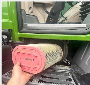
Filtre de cabine facilement accessible et disponible en option avec un système d'aspiration.
