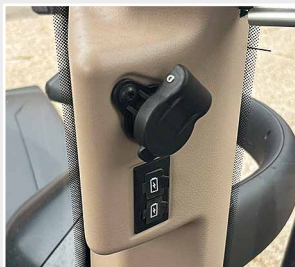
Prise à trois broches à l'avant, mais des ports USB-A et pas d'USB-C.
