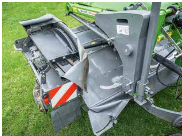
Przeciwwagi na kosiarkę czołową poprawiają rozkład masy, a silnik elektryczny służy do regulacji kondycjonera.
