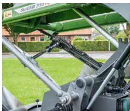
Za aktywne prowadzenie kosiarki czołowej odpowiada siłownik hydrauliczny.
