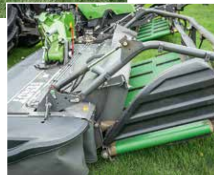
Taśmy wyposażono w dzielone, przykręcane listwy transportujące.
