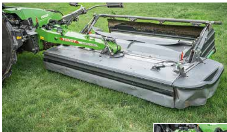
Ramiona utrzymują wysięgniki w osi, a siłownik stabilizuje uniesione zespoły tnące.
