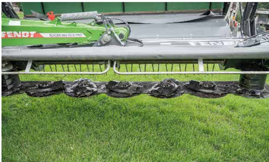
Belka Streamline, znana z innych kosiarek marki Fendt, zapewniła bardzo dobre cięcie.
