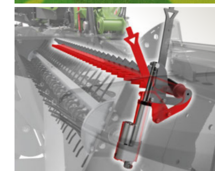
Elmotoren styrer trinløst modkammen på crimperen, der er ansvarlig for crimpringens intensitet
