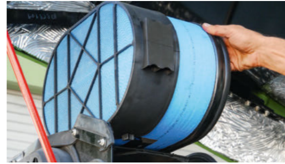
Повітряний фільтр можна легко замінити. В середині нього є датчик забруднення, який надає інформацію стосовно ефективності фільтра.
