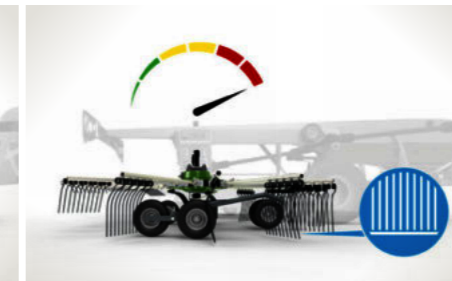
2 Øke kjørehastigheten Alle de fire rotorene senkes avhengig av kjørehastigheten til under forhåndsinnstilt rakehøyde.
