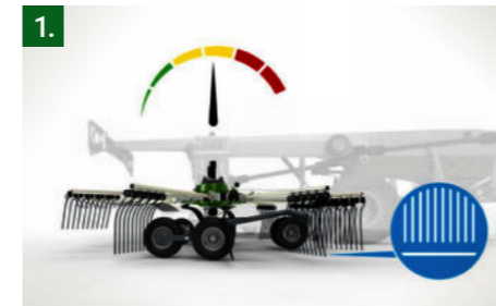
1 Start Alle de fire rotorene senkes til forhåndsinnstilt rakehøyde.
