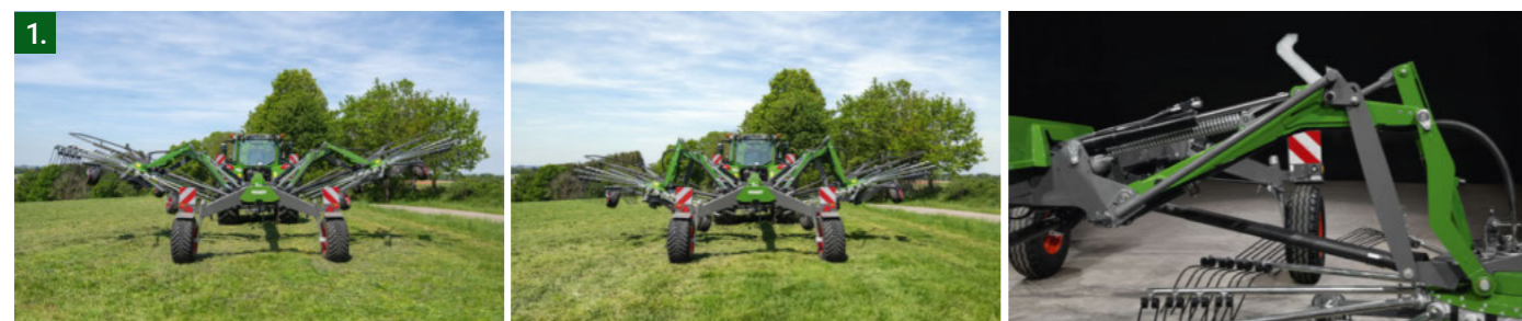
Streng-/arbeidsbreddejustering hydraulisk som standard og på PRO-modellen pr. ISOBUS
