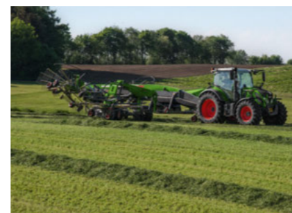
Den innovative sekvensstyringen skjer elektronisk via tids- eller distansesignal og kan tilpasses individuelt – takket være det nye ISOBUS-systemet.
