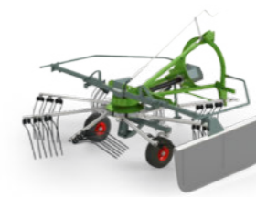
Trepunktsmontert med stiv koblingsramme – Alpin Alpinspecialister for tilkobling foran og bak Arbeidsbredder 3,60 m
