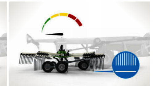
3 Stans Alle de fire rotorene løfter tindene til over innstilt rakehøyde.
