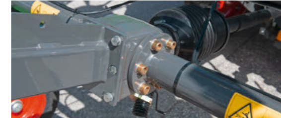
Pääkäyttöakselin ylikuormasuoja parantaa käyttöluotettavuutta ja tekee Lotus-pöyhimen voimansiirrosta erittäin kestävä.
