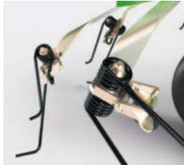
Koska pyörä on lähellä piikkejä, kone seuraa hyvin maaston muotoja.
