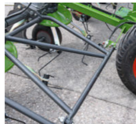
Perävaunupöyhimissä on lisäristikkorunko maksimaalista vakautta varten päärunnon suojaamiseksi ja vahvistamiseksi koko koneen leveydeltä.
