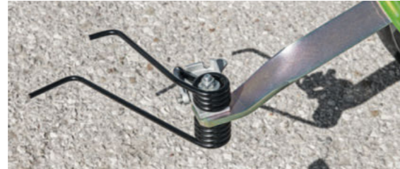
Piikkien erikoiskiinnitys ja säädettävä asetuskulma tarkoittavat, että vaihto rajalevitykseen tai yökarhoihin käy helposti, ja suojaavat piikkien menettämiseltä.
