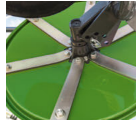
Suuret roottorilevyt tarkoittavat, että piikkien nopeus pysyy suurena alhaisella roottorin nopeudella.
