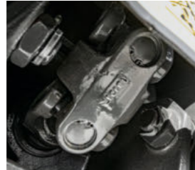
Huoltovapaat kaksoisristinivelet varmistavat suoran voiman siirron ja tarkoittavat, että pöyhin voi kääntyä myös taitetussa kuljetusasennossa.
