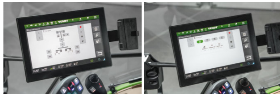
ISOBUS UT: valdymo šablonus galima perkelti į traktoriaus terminalą ISOBUS AUX-N: galimas vairavimo svirties perkėlimas
