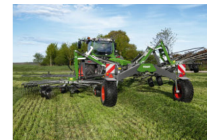
Dėl pakėlimo po vieną funkcijos švarus grėbimo rezultatas liekamuosiuose plotuose ir laukų pakraščiuose
