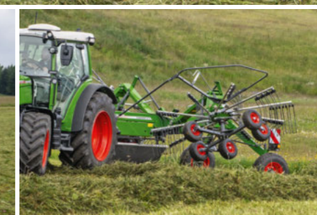
Galulaukėje arba transportavimo padėtyje sąvalkos uždanga automatiškai užlenkiama į viršų.
