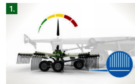
1. Važiavimo pradžia Visi keturi rotoriai nusileidžia į iš anksto nustatytą grėbimo aukštį.
