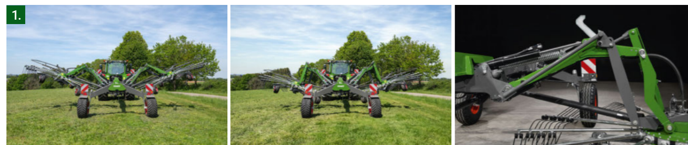
Serijinis hidraulinis sąvalkos ir darbinio pločio reguliavimas, o PRO modeliuose – per ISOBUS
