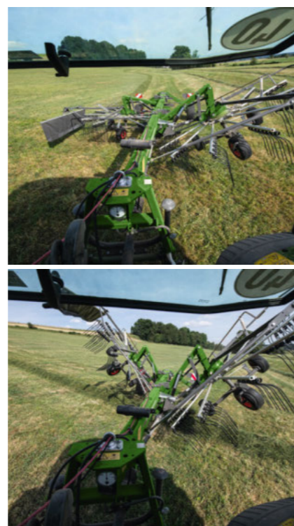
Serijinis nuoseklusis valdymas garantuoja tobulą sąvalką galulaukėje bei lauko pakraščiuose ir smailėse
