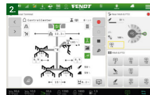
1. Važiavimo pradžia Visi keturi rotoriai nusileidžia į iš anksto nustatytą grėbimo aukštį.
