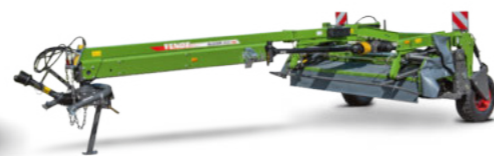
Segadoras arrastradas con chasis de transporte Alta flexibilidad con acondicionador de púas o de rodillos Anchura de trabajo: 3,00 m
