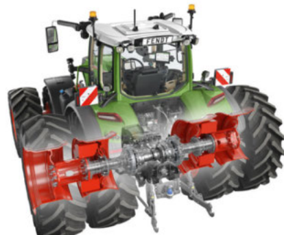
Eje trasero corto ruedas gemelas de 3000 mm con cubo de rueda dúo
