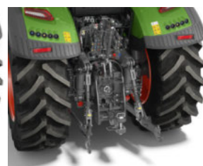
Elevador trasero con gancho de retención rápido y Rub Blocks (AU, Sudáfrica, Europa Oriental)
