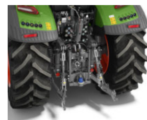
Elevador trasero con gancho de retención rápido y apoyo lateral (UE)
