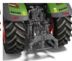
Bastidor Quick Hitch con apertura hidráulica del gancho de retención de serie
