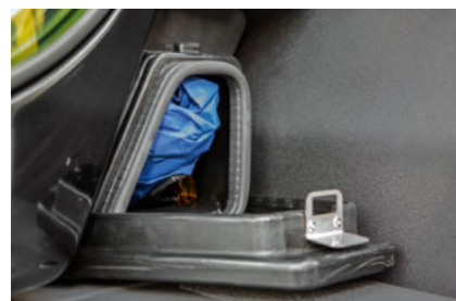
• Cimdu un aizsargapģērba uzglabāšanas nodalījums • Norobežo saskaņā ar CAT 4 sertificēto kabīni no PPE materiālu klātbūtnes
