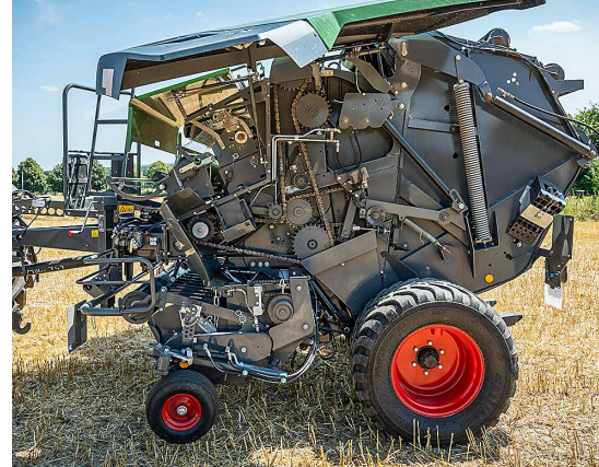
L'entraînement des outils de pressage s'effectue sur le côté gauche.
