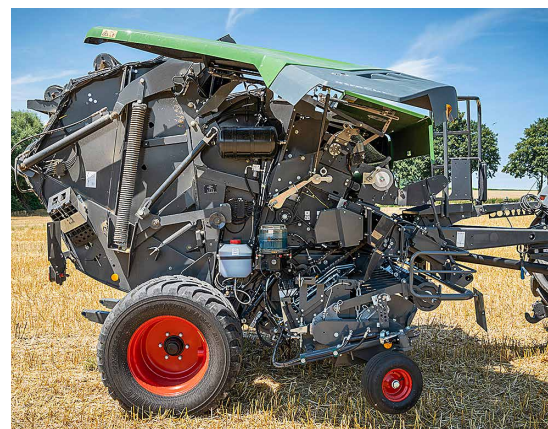
À droite se trouve, entre autres, le système de graissage centralisé.
