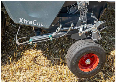
Le pick-up non commandé, associé au rouleau tasse andain et aux vis d'alimentation, assurent un flux de récolte régulier. Les roues de jauge pivotantes en PU sont recommandées.
