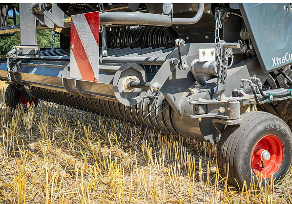
Le pick-up non commandé, associé au rouleau tasse andain et aux vis d'alimentation, assurent un flux de récolte régulier. Les roues de jauge pivotantes en PU sont recommandées.
