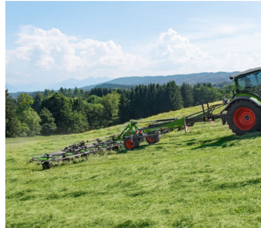
Üle kogu töölaiae on rootorite vahel mitu pöördliigendit, mis tagavad iga rootori sõltumatu ühildumise maapinnaga. Väike kulumine ja puhas sööt on tagatud.
