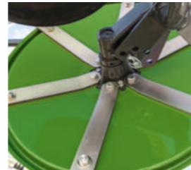
Tänu suurtele rootoridrikutele on piide joonkiirus ka rootori madalatel pööretel üsna suur.
