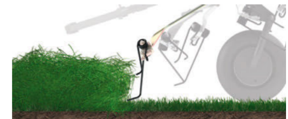
Eriti jäigad piiharud on loodud vahendama suurt jõudu ja tagama suurimat vastupidavust.
