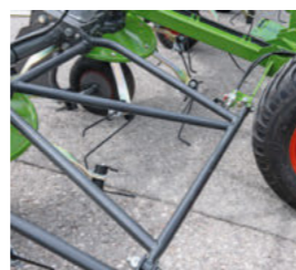
Järeelvetavatel kaarutitel on suurima stabiilsuse tagamiseks lisaraam, mis ühest küljest kaitseb ja tugevdab põhiraami masina kogu laiusel ning teisest küljest kaitseb ka kaarutit.
