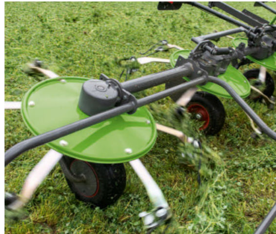
Suuremõõtmelised rehvid iga rootori all suurepäraseks sööda ülesvõtuks ja maapinna kopeerimiseks.
