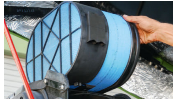
Luftfilteret er nemt at udskifte og har en smudssensor, som giver oplysninger om filtereffekten.
