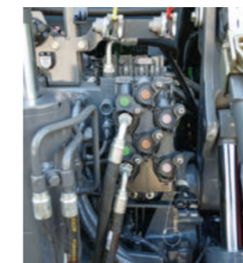
Hydrauliksystemet er konstrueret til maksimal ydeevne og giver mulighed for op til 440 l/min. ved 1.700 omdr./min.
