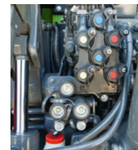
Hydrauliktilkoblingerne er farvekodede. Det gør det hurtigt og sikkert at tilkoble enheder.
