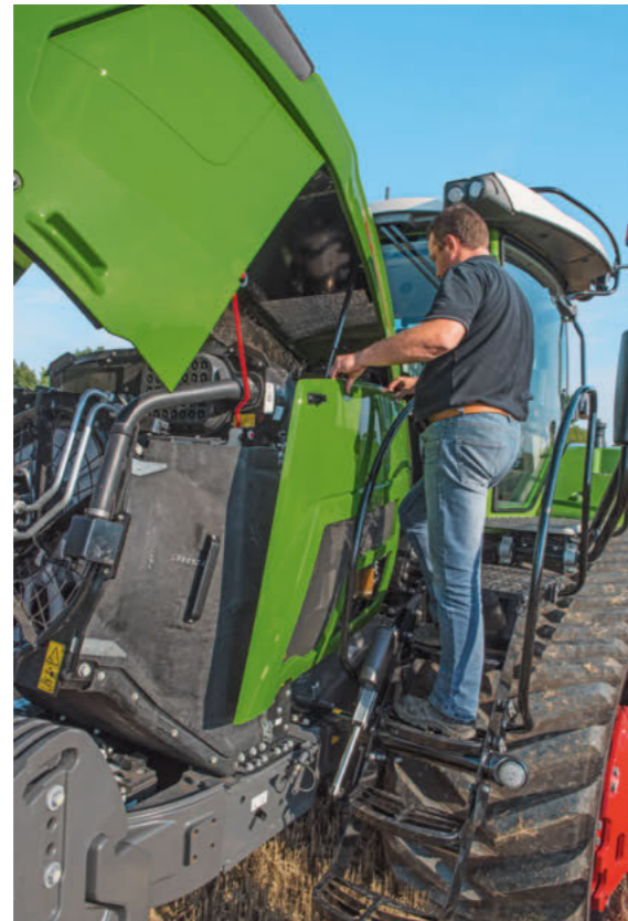
Motorrummet er let tilgængeligt, da sidepanelerne kan afmonteres.
