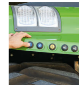
Bageste lift, PTO og styreenheden kan nemt betjenes fra bagskærmene.
