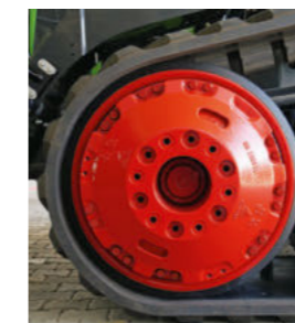
Frontstrammehjulene kan belastes med op til 1.580 kg.
