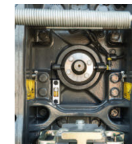
Vælg mellem to PTO omdrejninger: 1000 og 1000E.
