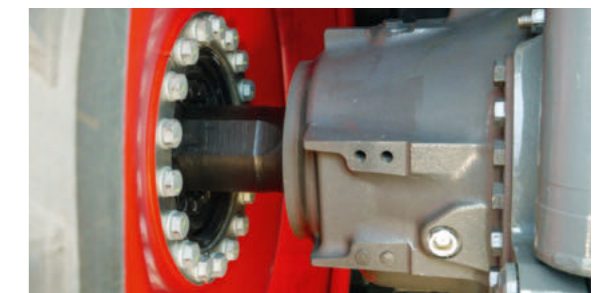
Den robuste bagaksel er konstrueret til meget lang levetid. Den interne oliebalance er nem at kontrollere ved hjælp af inspektionsglasset.
