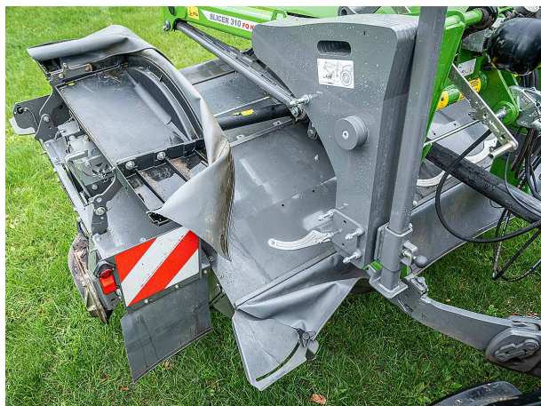
Die Kontergewichte am Frontmäher optimieren die Lastverteilung. Der Elektrostellmotor (oben) justiert den Aufbereiter.
