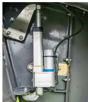
Die Kontergewichte am Frontmäher optimieren die Lastverteilung. Der Elektrostellmotor (oben) justiert den Aufbereiter.
