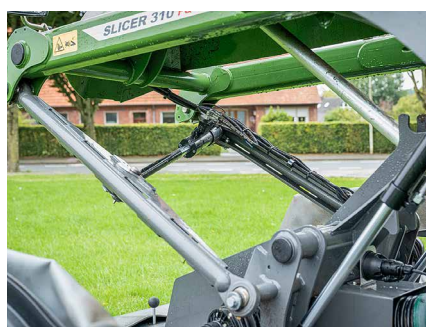
Der Hydraulikzylinder übernimmt die aktive Anlenkung des Frontmäherwerks.
