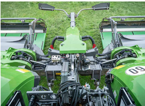
Der Anbaubock ist massiv ausgeführt. Es gibt erfreulich viel Platz für den An-/Abbau.
