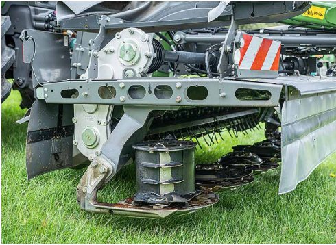
Der Aufbereiter-Antrieb erfolgt mit einem Getriebe.
