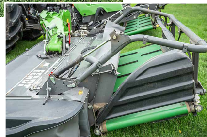
Die Bänder haben jetzt aufgeschraubte und geteilte Förderleisten.
