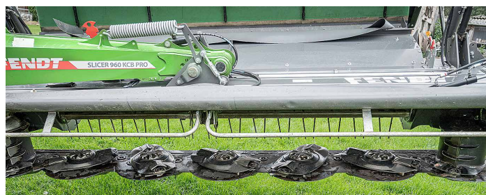
Der Streamline-Mähbalken ist von Fendt bekannt und hat im Test ein sehr ordentliches Schnittbild abgeliefert.
