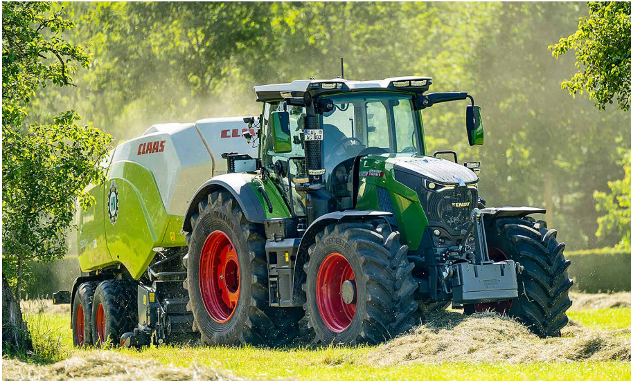
Le quattro velocità della presa di forza consentono un impiego universale del trattore.
