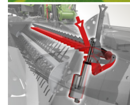
En elektrisk motor styrer motstålet på stengelbehandleren trinnløst; den regulerer intensiteten i behandlingen
