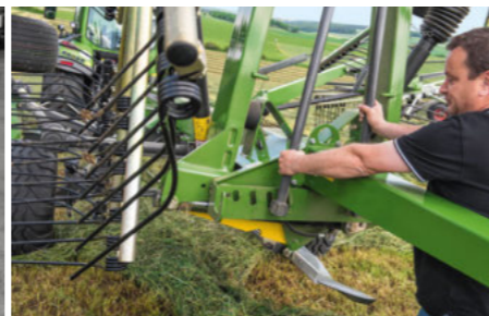
Просте управління і низькі вимоги до трактора при регулюванні ширини валка Former 12545.
