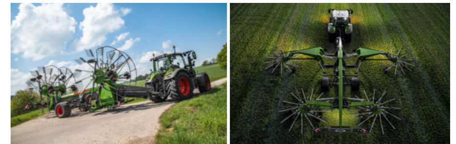
Інтелектуальне зчеплення: кутовий датчик попереджає про занадто різкі повороти.
