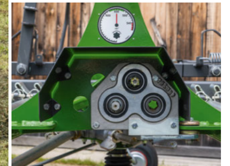
Універсальний редуктор з легкосплавного лиття для роботи при передньому і задньому навішуванні.
