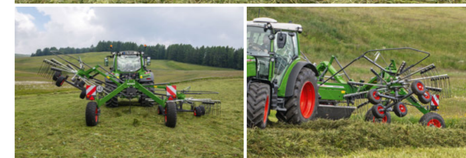
Фартух-валкоутворювач автоматично відкидається догори на поворотній смузі та в транспортному положенні.
