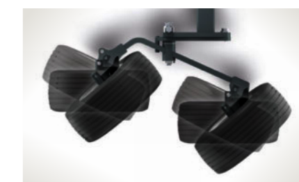
Опціональна керована здвоєна вісь грабелів Former 7850 забезпечує оптимальне копіювання ґрунту навіть на поворотах, знижує пробуксовку і тим самим захищає трав'яний покрив..
