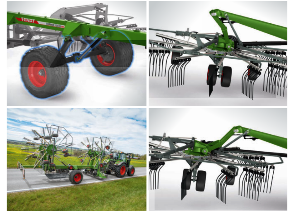
Шини великого об'єму на підйомній осі також забезпечують зниження тиску на ґрунт.
