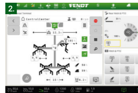
1 Запуск Усі чотири ротори опускаються до заданої висоти зрібання.
