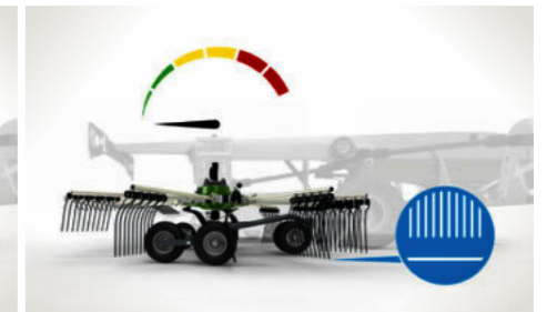
3 Простій Усі чотири ротори піднімають зубці вище заданої висоти зрібання.
