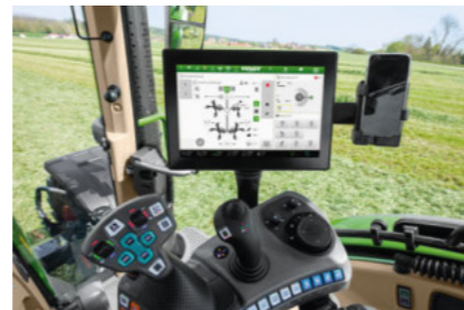
ISOBUS UT: Екрани операторського управління можуть бути передані на термінал трактора ISOBUS AUX-N: Можлива передача функцій на важіль керування
