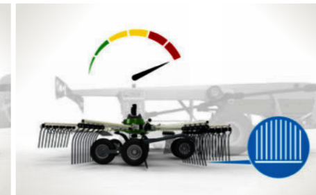
2 Підвищення швидкості руху Усі чотири ротори опускаються нижче заданої висоти зрібання залежно від швидкості руху.
