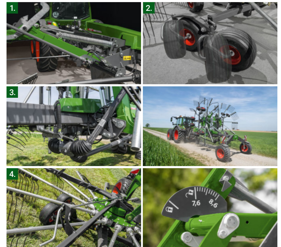
Vaalutuskõrgust saab standardmudelitel lihtsalt ja kiirelt hammasratas käsiajamiga seadistada, PRO-mudelitel hüdrauliliselt
