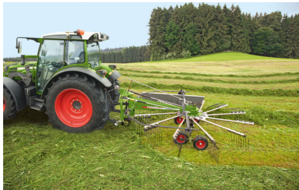
Tellimisel lisavarustusena soetatav kahe rattaga tandemtelg
