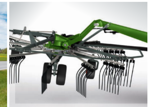
Funktsionaalne, sujuv töölaie kohandamine tänu patenteeritud rootorite paralleelse tõstmise topeltvõllile
