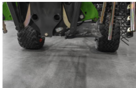
Tellimisel lisavarustusena soetatavat hüdraulilist vaalulauda klapitakse automaatselt kokku rootorite ülestõstmisel, see lihtsustab ülesõitmist kõrgetest vaaludest ja transportimist ebatasastel põlluteedel.
