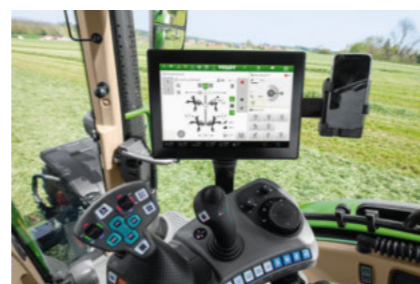
ISOBUS UT: universaalterminal: töömenüüd saab üle kanda traktori terminalile ISOBUS AUX-N: funktsioone saab üle kanda ka juhtkangile
