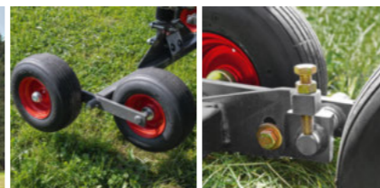
Tellimisel lisavarustusena soetatav kahe rattaga tandemtelg
