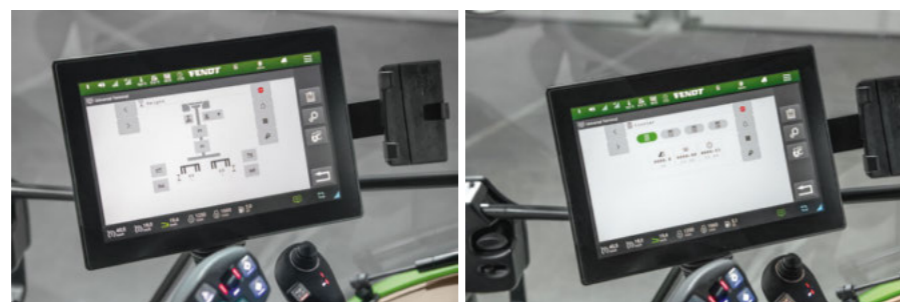
ISOBUS UT: universaalterminal: töömenüüsid saab üle kanda traktori terminalile ISOBUS AUX-N: funktsioone saab üle kanda ka juhtkangile
