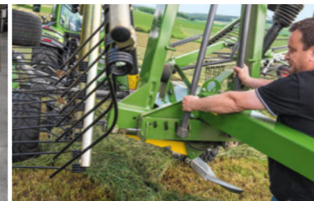
Lihtne juhtimine ja vähene traktori koormamine Former 12545 vaalulaiuse reguleerimisel
