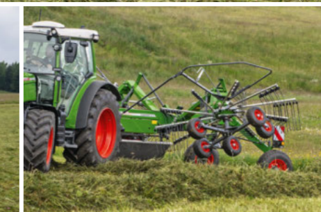
Vaalukangas klapitakse põlluotstes ümberpööramiseks või transpordiasendis automaatselt üles.
