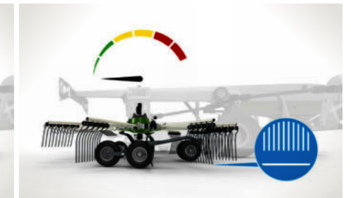
3 Parada Los cuatro rotores elevan las púas por encima de la altura de hilerado establecida.
