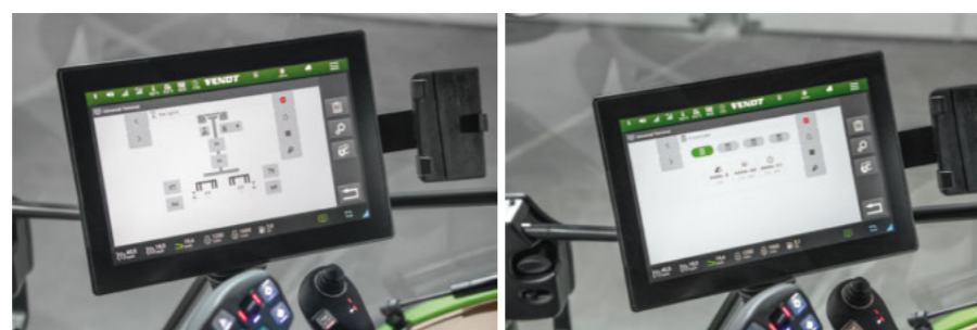
ISOBUS UT: Se pueden transmitir las máscaras de mando al terminal del tractor ISOBUS AUX-N: se puede transferir al joystick
