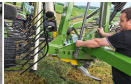
Fácil manejo y baja exigencia de potencia del tractor en el ajuste de la anchura de hilera del Former 12545.
