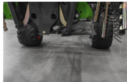
El hilerador hidráulico opcional se pliega automáticamente al subir los rotores y facilita atravesar hileras grandes y transportar en caminos irregulares.
