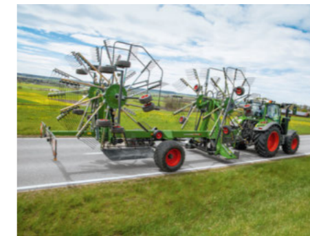
Los neumáticos de gran volumen para el eje elevable garantizan también una baja presión sobre el terreno.
