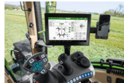
ISOBUS UT: las pantallas de funcionamiento se pueden transferir al terminal del tractor ISOBUS AUX-N: se puede transferir al joystick
