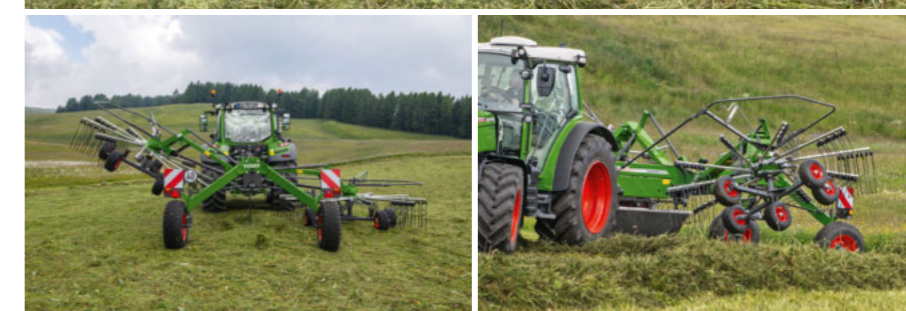
La lona de hilerado se repliega automáticamente hacia arriba en la posición de cabecera o de transporte.
