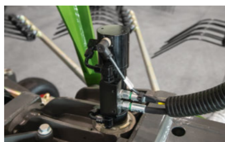
Con el ajuste hidráulico de la altura del hilerador de confort, basta con ajustar un 'rotor maestro'. Los demás rotores se adaptan automáticamente.
