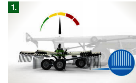
1 Arranque Los cuatro rotores bajan a la altura de hilerado preestablecida.
