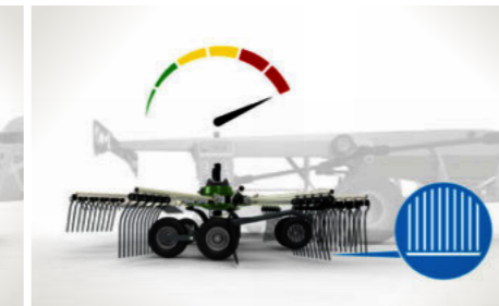
2 Acelerar Los cuatro rotores bajan por debajo de la altura de hilerado preestablecida en función de la velocidad de marcha.
