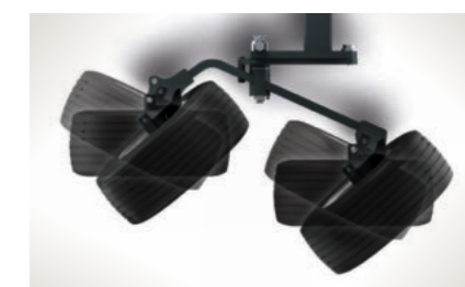
El eje tándem dirigible opcional del Former 7850 permite el seguimiento óptimo en el suelo en curvas, reduce el derrape y protege la cubierta vegetal.
