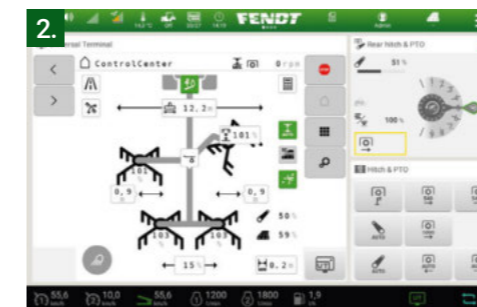
1 Arranque Los cuatro rotores bajan a la altura de hilerado preestablecida.
