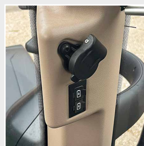
Gut: dreipoliger Stecker vorne, aber USB-A-Dosen, kein USB-C.
