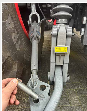
Hochgesteckte Unterlenker visuell kaum erkennbar.
