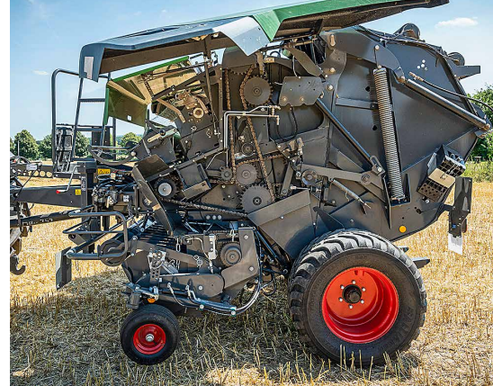
Auf der linken Seite erfolgt der Antrieb der Presswerkzeuge.
