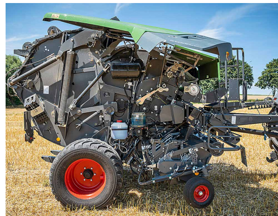
Rechts ist unter anderem die Zentralschmierung untergebracht.
