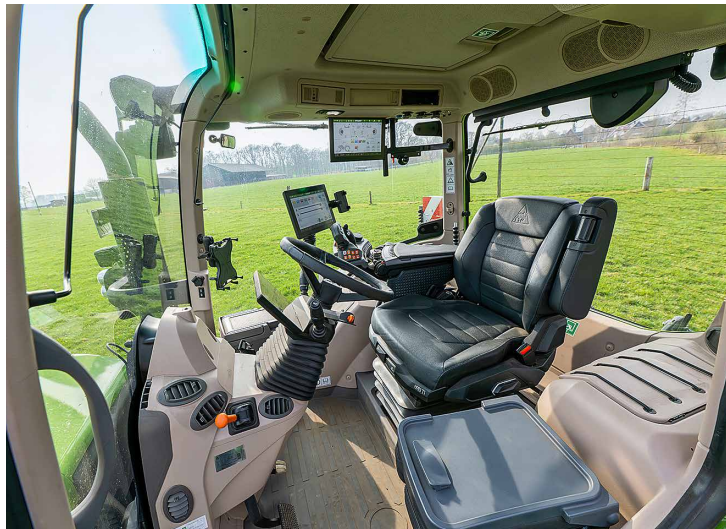
Der elektrisch einstellbare Sitz von Isringhausen passt sich dem Fahrer automatisch an, wenn das Profil im Terminal geändert wird. Der Sitzkomfort ist prima. Unbedingt auswählen: die automatische Parksperre. Dann ist der Hebel unten links überflüssig.
